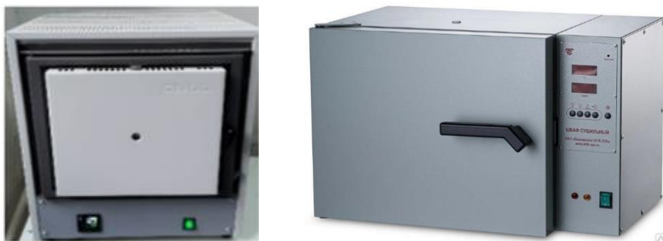
10 Сурет. Муфель пешінің және кептіру шкафының жұмыс істеу барысындағы сырт пішіні
