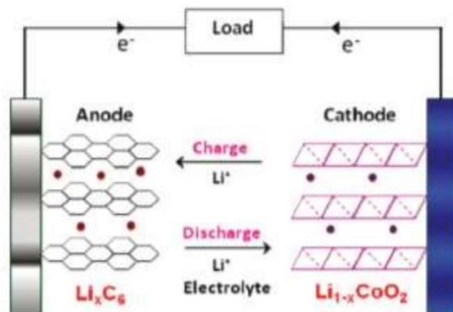
4 Сурет. Литий-иондық элементтегі заряд/разряд процесінің иллюстрациясы, анод ретінде графит және катод ретінде \text{LiCoO}_2 қабаты.
