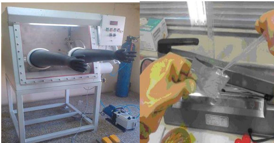
16 Сурет. Батареяны жинау негізгі құрылғы қолғап жәшігі және осы жәшік ішінде батарея жинау процесі.
